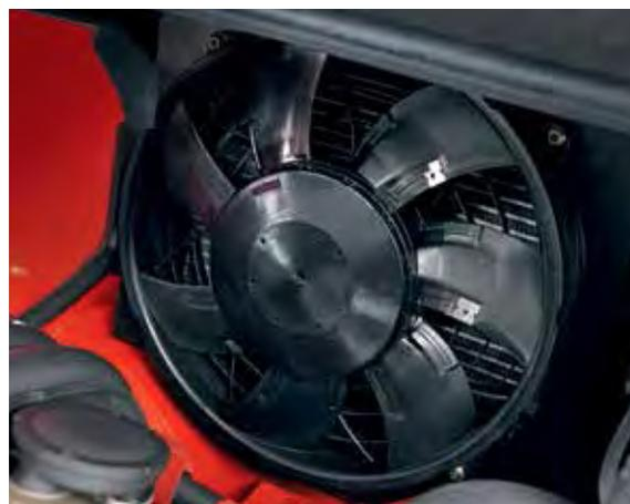
**Ricercatezza in ogni dettaglio finale.** La nuova ventola elettrica adatta la propria velocità alla temperatura dell'olio idraulico, dell'acqua di raffreddamento e dell'aria, rendendo il carrello ancora più economico.
