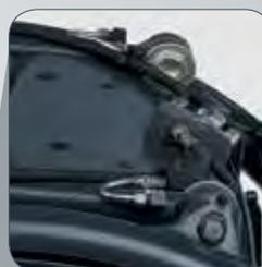
Testate per impieghi pesanti e continuativi. Disaccoppiamento del montante e dell'asse di trasmissione dal telaio e dalla cabina dell'operatore per ridurre notevolmente gli urti.
