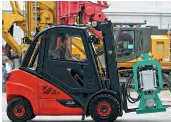
L'utilizzo di un **rallentamento elettronico di fine corsa** evita duri colpi quando i cilindri di brandeggio si avvicinano al fine corsa.
