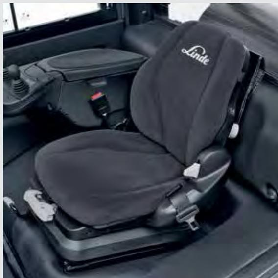
Oltre ad una copertura in tessuto resistente alle abrasioni, il **sedile comfort**, rivestito con carboni attivi, offre un sostegno meccanico lombare ed una sospensione pneumatica in opzione.
