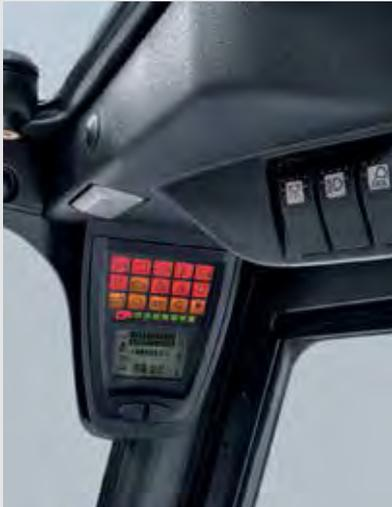
Il **display** è montato nella parte superiore dell'abitacolo in modo da essere sempre ben visibile per l'operatore. I simboli illuminati sono facilmente riconoscibili.
