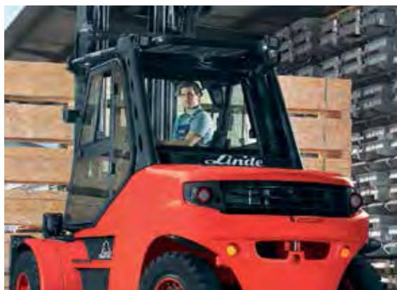
**Posto di lavoro girevole** con pedali e dispositivi di comando totalmente girevoli. Sia che si proceda in avanti che indietro, l'operatore, con un leggero movimento della testa, ha sempre sotto controllo il carico ed il percorso.
