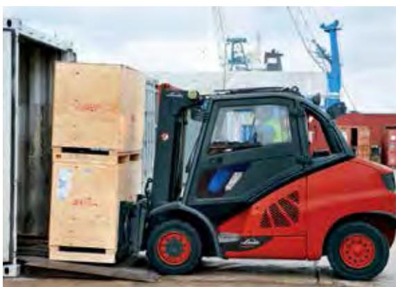
**Ideale per ingressi ribassati.** Anche per il potente carrello da 5 tonnellate, Linde offre una versione con un'altezza di appena 2,22 m.
