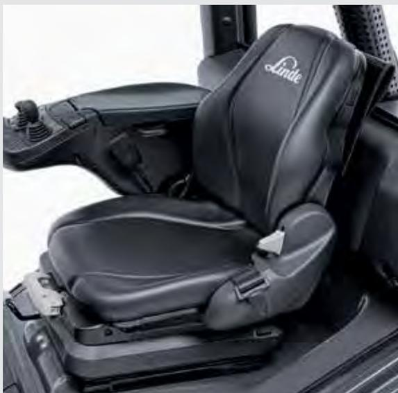
Il **sedile di serie del carrello** è di similpelle, duratura e resistente allo sporco. Il sistema di sospensione a molla offre una corsa delle molle di 60 mm per operatori che pesano fino a 130 kg.
