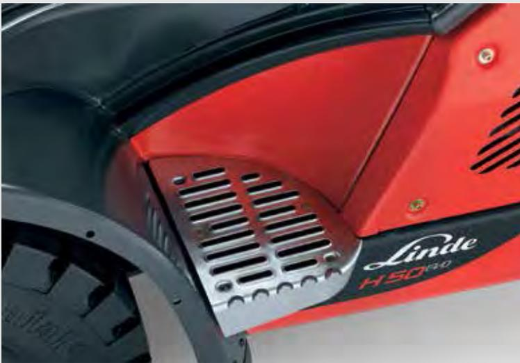
Il **gradino in acciaio inossidabile**, stabile, permette all'operatore di scendere e salire in tutta sicurezza.
