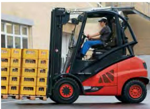
Carrello Linde in esecuzione per l'industria bevande. Grazie alla **cabina rialzata**, l'operatore ha una buona visibilità anche con carichi ingombranti in altezza.
