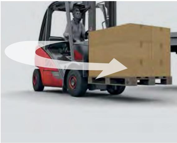
Linde è il primo costruttore mondiale ad includere di serie la funzione di sicurezza **“Curve Assist”** sui modelli H20-H50. In caso di curve troppo veloci, il sistema adegua automaticamente la velocità del carrello. Questo significa che il carrello può essere usato fino al massimo della sua efficienza, ma non oltre.
