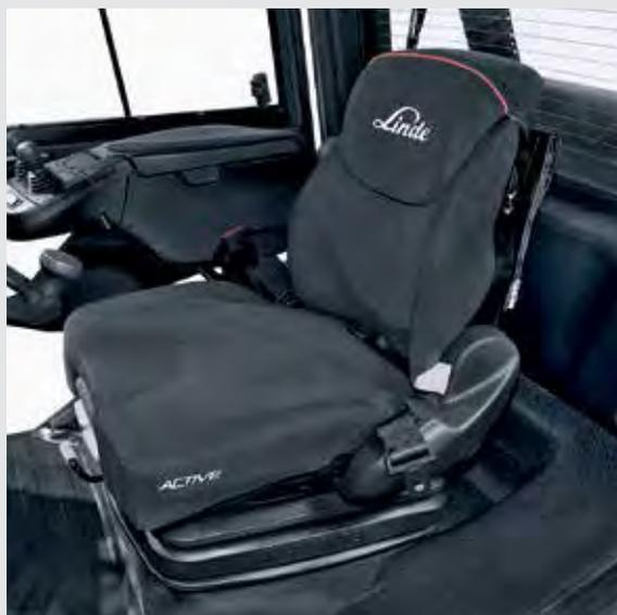
Comfort elevato per lunghi periodi di utilizzo. Il sedile **super comfort active** con seduta e schienale ergonomici e, per la prima volta sui carrelli, con controllo della temperatura a ventilazione attiva.
