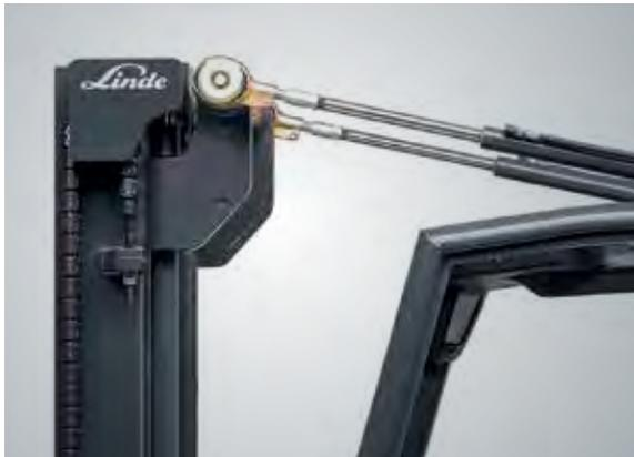
Perfetta divisione dei compiti. I **cilindri di brandeggio montati sul tettuccio** consentono l'impiego di profili del montante molto più sottili, senza perdita di portata, ma garantendo maggior sicurezza.
