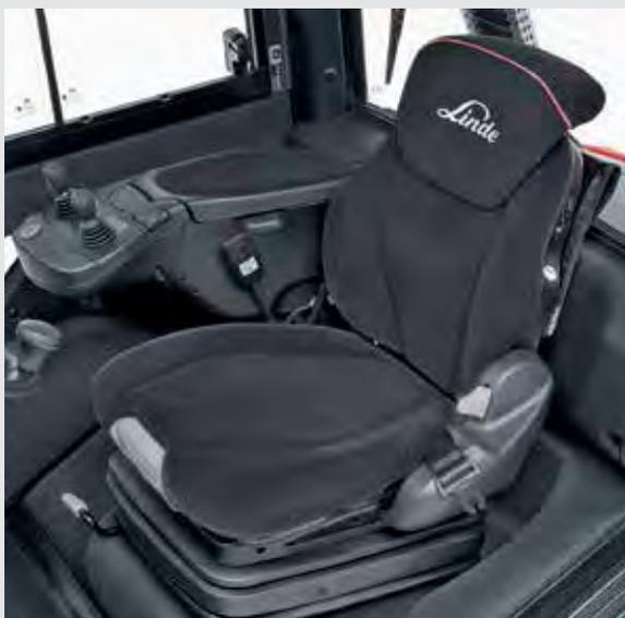
Il **sedile super comfort** Linde, con sospensione pneumatica di serie, dispone di un sistema di riscaldamento della seduta e dello schienale, di una prolunga dello schienale e di una regolazione della profondità e dell'angolazione del cuscino.
